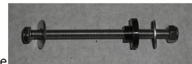
**Pour les hors-bords n'ayant que 1 seul boulon du côté droite et gauche en haut de la platine: Placez un 2<sup>ème</sup> boulon stabilisant, en laissant de 1 à 3 trous libres entre le boulon d'origine et le boulon stabilisant.**
