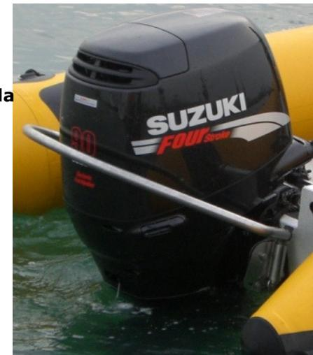
Remettez le moteur hors-bord dans sa position la plus basse avant de régler l'angle "pre-trim".
