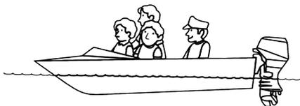
Augmenter l'angle d'assiette en appuyant sur UP (montée) au commutateur d'inclinaison/assiette automatique.
