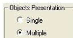
Im Single Modus werden mehrere Objekte als ein Symbol dargestellt im Multiple Modus wird jedes Objekt einzeln dargestellt.
