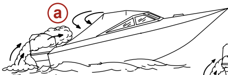
a- Angle de relevage de la proue trop élevé.
