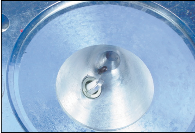
Positionnement de l'injecteur dans la chambre de combustion. Veuillez noter que l'écartement des électrodes est indexé pour faire face à l'injecteur (afin d'assurer une combustion plus efficace en mode stratifié).
