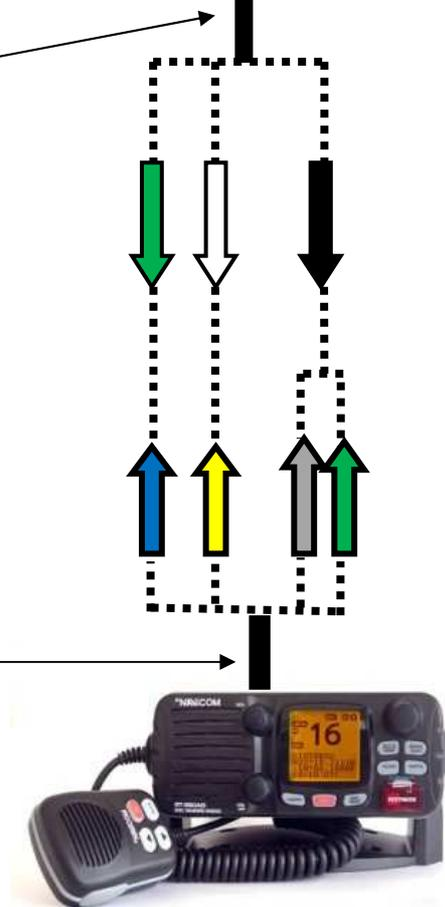
**Sur la vhf** : Dans le menu Ais Setup sur l'onglet « **Baud rate** » il faut modifier la vitesse par **4800Bds**.
