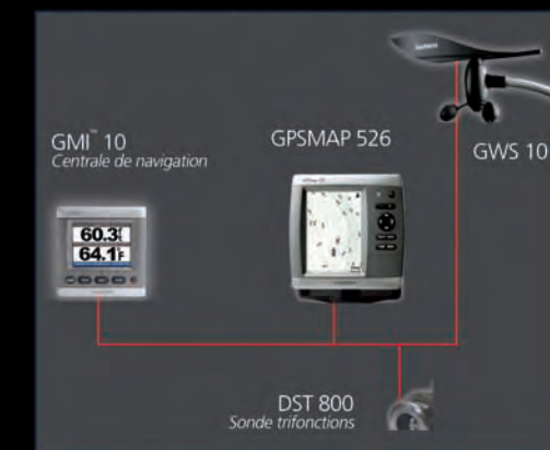
Exemple de réseau type : installation voile
