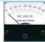
BLUE SEA Voltmètre Voltmètre gradué de 8 à 16V, précision 3%. Dimensions du boîtier (L x h) 71,12 x 60,33 mm. 403058
