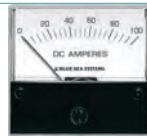
BLUE SEA Ampèremètre 100A Ampèremètre analogique 100A, précision 3%. Avec shunt externe fourni. Dim. du boîtier (L x h) 71,12 x 60,33 mm. 403062
