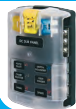
BLUE SEA Porte-fusibles 6 voies Porte-fusible avec bus négatif. Corps en Lexan, couvercle translucide en polycarbonate. Umax par voie 30A. Umax totale 100A. Utilise des fusibles ATO/ATC (type voiture). Dim. hors tout 84,20 x 124,31 mm. 403066
