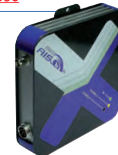
WEATHERDOCK EasyAIS Récepteur AIS double canaux, équipé d'un nouveau processeur. Il peut être connecté à sa propre antenne ou à l'antenne VHF du bord en utilisant un splitteur d'antenne (voir ci-dessous). Alimentation 12 ou 24 V. Boîtier 140 x 140 x 35 mm. Livré avec le câble d'alimentation + data et un adaptateur PC (port série). 103528
