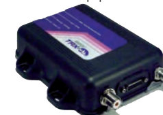
WEATHERDOCK EasyTRX Emetteur-récepteur AIS Classe B, en boîte noire, pouvant être connecté à un PC ou à un lecteur de cartes compatibles. Equipé d'un récepteur GPS interne (antenne GPS avec connecteur BNC non livrée), il peut être connecté à sa propre antenne VHF ou à l'antenne VHF du bord en utilisant le splitteur d'antenne « EasySplit Classe B » (voir ci-dessous). Alimentation 12 V. Boîtier 140 x 140 x 35 mm. Livré avec le câble d'alimentation + PC (port série) et un logiciel pour la programmation, du numéro MMSI, des informations de votre navire et l'utilisation sur un PC. L'émetteur peut-être déconnecté. 103530
