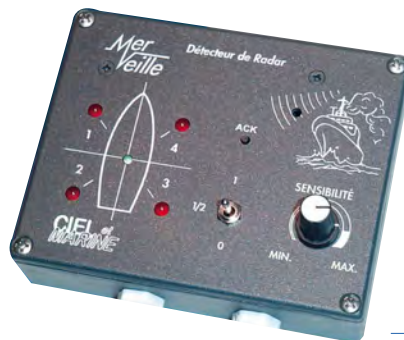
MER-VEILLE Détection des émissions des radars alentours et vous informe par une alarme sonore et 4 diodes de la direction du navire émettant les ondes radar. Composé d'un boîtier intérieur et d'un aérien avec câble de 15m (support d'aérien en option). Alimentation 12V. Consommation 10mA en veille. 116008
