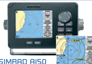
SIMRAD AIS0 Emetteur-récepteur AIS Classe B, double canaux, équipé de son propre écran couleur plein soleil (60x80 mm). Cartographie mondiale incluant le contour des côtes. Livré avec une antenne GPS, il peut être utilisé seul ou couplé à un PC ou lecteur de cartes compatibles. Interface Simnet, NMEA2000 et NMEA0183. Alimentation 12V. Boîtier 115 x 172 x 77 mm. Doit être connecté à une antenne VHF (non livrée). 103524
