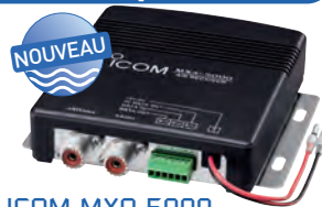
ICOM MXA-5000 Récepteur AIS double canaux, avec splitter d'antenne VHF intégré (entrée antenne VHF-sortie radio VHF). Interface NMEA0183 pour le connecter à un PC ou un lecteur de cartes, compatibles. Doit être relié à une antenne GPS ou un récepteur GPS, via le NMEA0183. Alimentation 12V (0.25 A). Boîtier 132 x 155 x 34 mm. 103552
