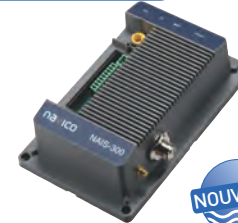
NAVICO NAI300 Emetteur-récepteur AIS Classe B, double canaux, en boîte noire, pour connecter à un PC ou un lecteur de cartes, compatibles. Interface Simnet, NMEA2000 et NMEA0183. Livré avec une antenne GPS. Alimentation 12V. Boîtier 167 x 210 x 74 mm. Doit être connecté à une antenne VHF (non livrée). 103543
