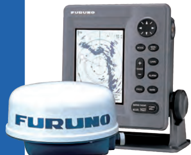
FURUNO M1623 La référence des radars pour les petites unités. Ecran de 6", 320 x 240 pixels. Radôme Ø 38 cm, HT 24 cm, puissance de 2,2kW, poids 4,5 kg. Portée maxi 16 mn. Connexion NMEA0183. Alimentation 12 à 24V. Ecran 195 x 185 mm. Livré avec un câble de 15m, un étrier pour l'écran et un capot de protection. 116001
