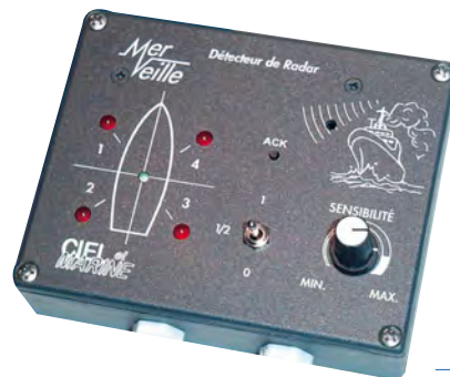
MER-VEILLE Détection des émissions des radars alentours et vous informe par une alarme sonore et 4 diodes de la direction du navire émettant les ondes radar. Composé d'un boîtier intérieur et d'un aérien avec câble de 15m (support d'aérien en option). Alimentation 12V. Consommation 10mA en veille. 116008
