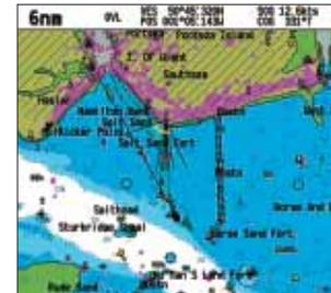
Les modèles couleur équipés de Raychart superposent directement les cibles Pathfinder en temps réel sur les cartes détaillées C-MAP NT+.
