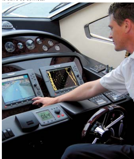
Sondeur. Affichage agrandi (en bas à gauche) de l'image sondeur principale et affichage des données de navigation dans la barre de données.
