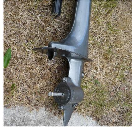
Puis retirer l'hélice et les 2 écrous qui sont derrière elle afin de visualiser et éventuellement changer la turbine
