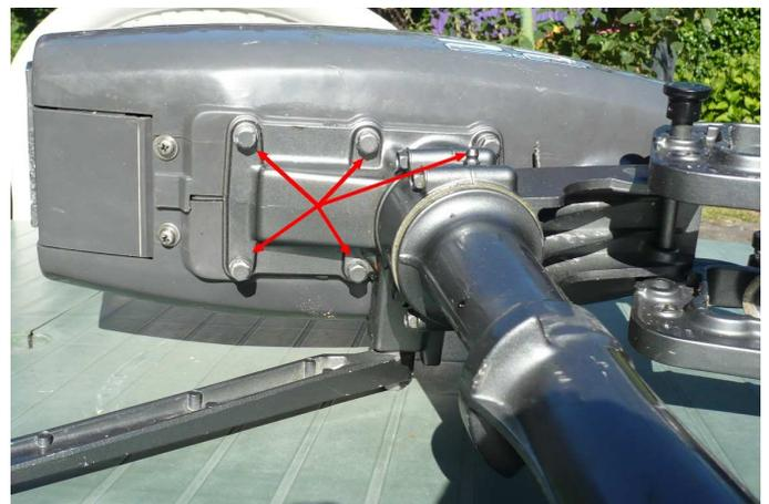
Voilà on nettoie les entrées et sortie d'eau (tournevis, couteau puis on retire la culasse (4 boulons) et on accède à l'espace à nettoyer entre le cylindre et la chemise.
