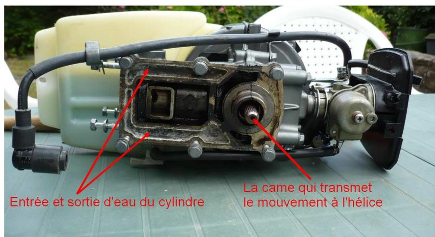
On retire le joint entre la culasse et le cylindre et on nettoie le circuit de refroidissement de la culasse
