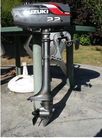
Le constat est simple : mon hors bord ne refroidit plus, je peux peine poser la main sur l'embase tellement c'est chaud. C'est parti pour un démontage afin de nettoyer le circuit de refroidissement
